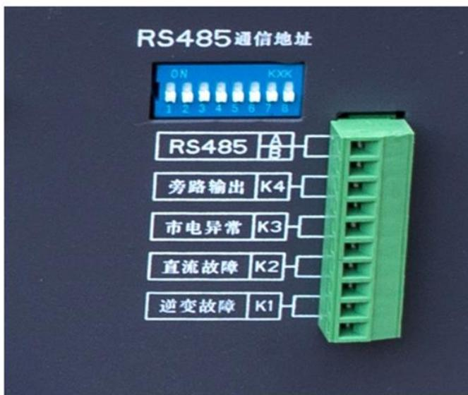
RS485 接口支持 MODBUS RTU 通信协议，默认地址为 185。
